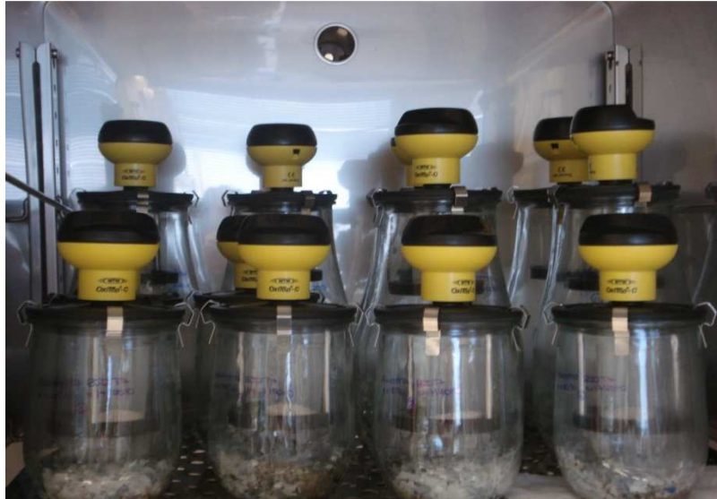
Figura 9 – Pormenor fotográfico dos ensaios de CBO efectuados em ambiente climatizado.
